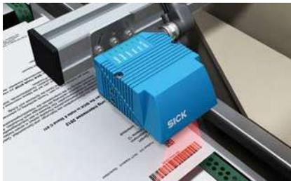
Die Barcodescanner CLV6xx werden zur Identifikation von Dokumenten eingesetzt. Sie helfen z. B. bei der Sortierung von Briefen.
