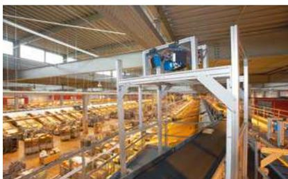
Das Erfüllen omnidirektionaler Leseaufgaben in modernen Logistiksystemen wird mit Omni Port Systemen (OPS) realisiert. Leistungsstark und flexibel durch die Verwendung von Einzelscannern.
