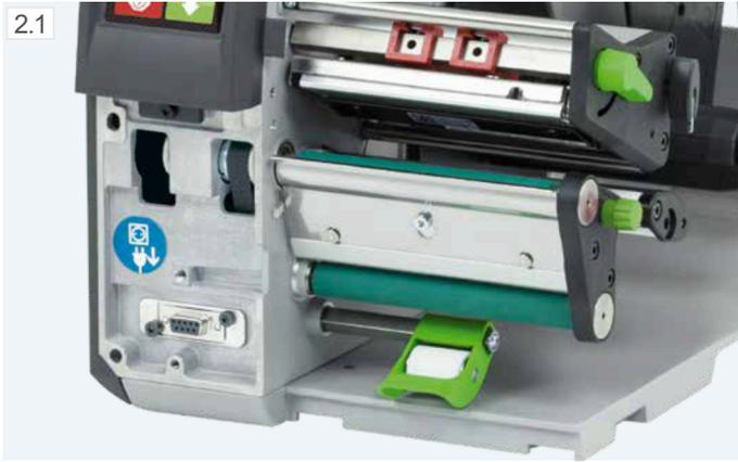
**Alle Druckköpfe sind bei gleicher Breite beliebig austauschbar. Sie werden von der CPU automatisch erkannt und kalibriert.** Wichtige Daten wie Laufleistung, maximale Betriebstemperatur und Heizenergie werden direkt im Druckkopf gespeichert. Die Werte können im Werk ausgelesen werden.
