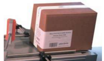
Etikett wird mit Hilfe der Anrolleinheit umeck angeedrückt
